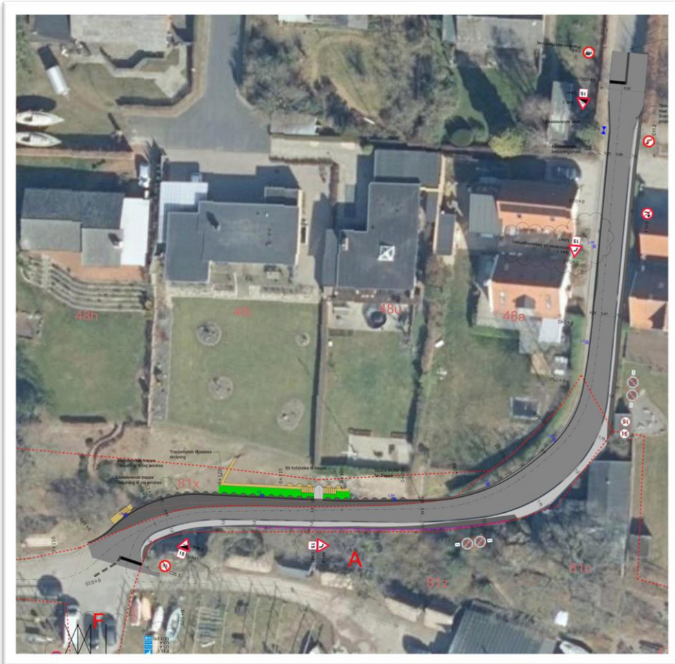
Figur 1: Plantegning for konkretiseret og godkendt vejprojekt (Signalreguleret løsning).
